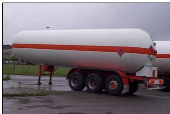
Figura 5.11: sezione cilindrica con calotte semisferiche
