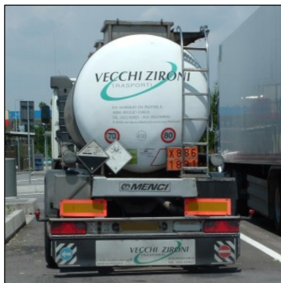
Figura 5.12: sezione cilindrica, quasi sempre in acciaio inox, con cisterna di dimensioni ridotte a causa del maggiore peso specifico della sostanza.
