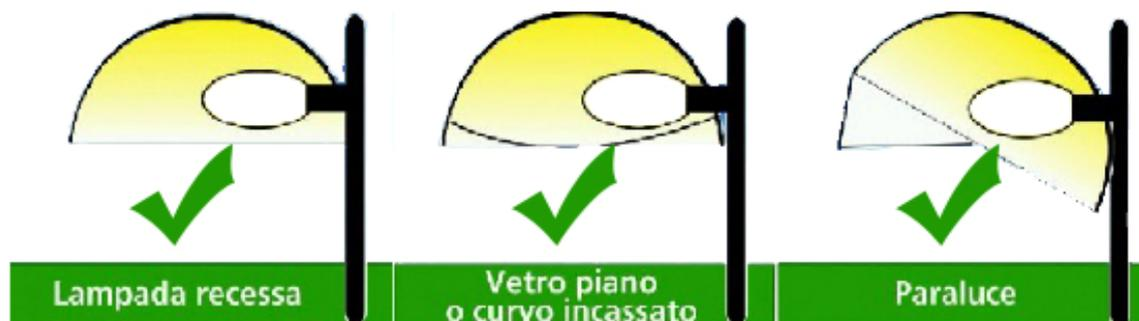
Per verificare il valore dell'intensità luminosa per angoli gamma di  $90^\circ$  ed oltre e la conformità di un apparecchio alla LR Lombarda 17/00, non è sufficiente una sommaria visione della curva fotometrica in cui spesso è difficile intuire i valori di intensità luminosa emessi per angoli vicini e maggiori di  $90^\circ$ , ma è indispensabile possedere e verificare i dati fotometrici in formato tabulare numerico.
