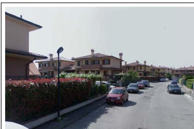
Strada privata Via XXV Aprile: l'impianto di illuminazione è composto da pali alti 4 m f.t. con apparecchi illuminanti a testapalo orientati non parallelamente al piano da illuminare e quindi non in modo non corretto.
